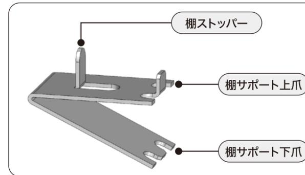
棚サポートを取り外す際は、棚サポート下側を上押ししながら、棚サポート下側爪を引いてください。
