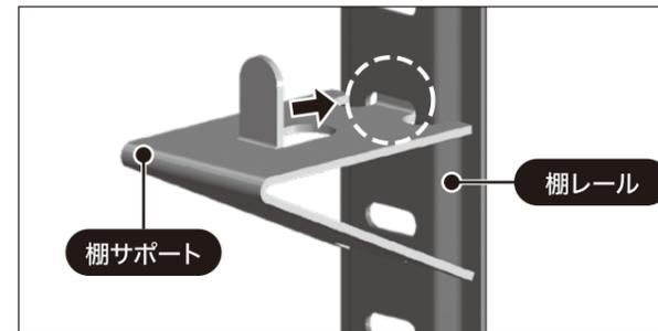
① 棚サポート上爪を棚レールの穴に差し込む。
