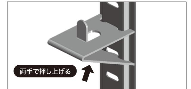
② 両手で、棚サポートの下側を上押ししながら、棚サポート下爪を差し込む。
