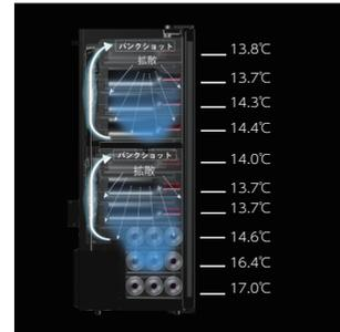
従来のセラーが抱えていた問題の一つが庫内の温度差。センサー付近の温度が14℃でも、実際の庫内温度は違いました。庫内の温度差をなくすために開発したワインの熟成のための特別な冷却方式です。
