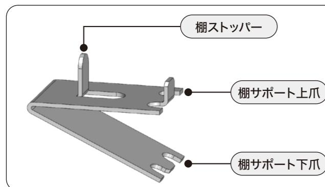
棚サポートを取り外す際は、棚サポート下側を上に押し上げながら、棚サポート下側爪を引いてください。
