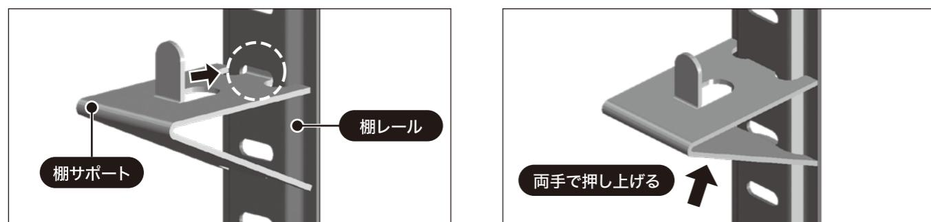
① 棚サポート上爪を棚レールの穴に差し込む。
